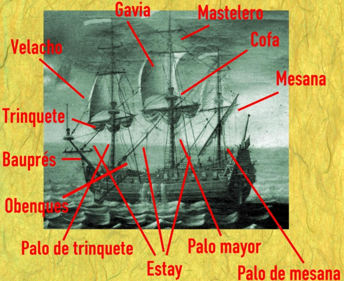
delante y, [obenques](#) que lo hacían hasta las vigotas en los costados del buque. Navegando resultaba, para evitar el movimiento y caída de [palos](#) y mástiles, básico mantener siempre tensos los cordelajes.
